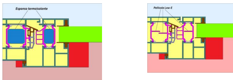
Figura a sinistra: U_f = 1,8 \text{ W/m}^2\text{K} : Profilo termoisolante insulbar con espanso ( in blu)
