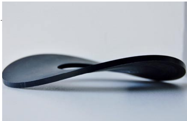
A fianco, deformazione in un distanziale in Tecast TM (PA6G + MoS2)
