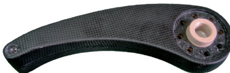
Fig. 3 - Il nuovo braccio robotico dove l’inserto in alluminio è stato sostituito da quello in TECAPEEK
